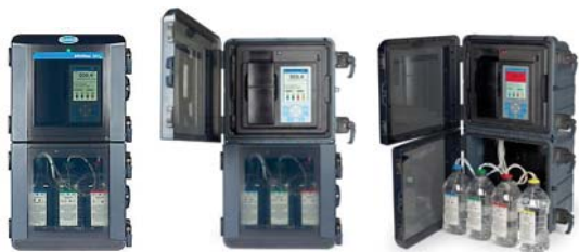
ภาพ แสดงลักษณะของเครื่องวัดซิลิกาในน้ำของบริษัท HACH ประกอบไปด้วย 3 Buffer เป็นสารที่ใช้ทำปฏิกิริยากับน้ำ Sampling เพื่อวัดค่าซิลิกา 1 Buffer สำหรับสารซิลิกาคงที่ใช้สำหรับสอบเทียบเครื่องวัด
