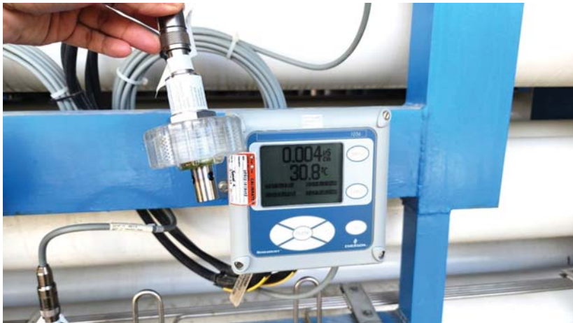
ภาพ แสดงการสอบเทียบกับอากาศ เนื่องจากในอากาศจะไม่มีค่าความนำไฟฟ้า
