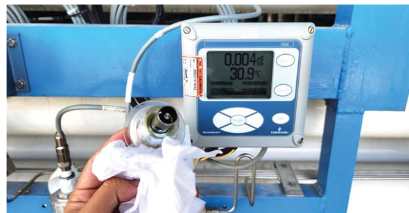
ภาพ แสดงการใช้ที่เช็ดซับ เพื่อทำความสะอาดหัววัด
