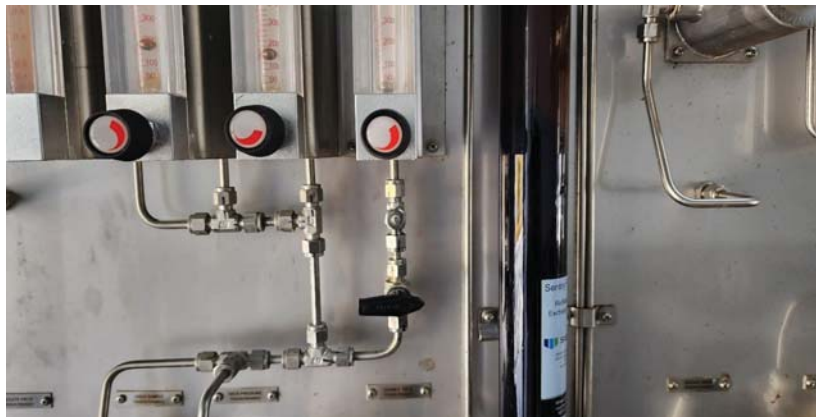
ภาพ แสดงการปรับลือควาล์วเพื่อ น้ำ N2 เข้าระบบ เนื่องจาก N2 จะไม่มีส่วนผสมของออกซิเจน ทำให้ค่าที่อ่านได้ต้องเท่ากับศูนย์
