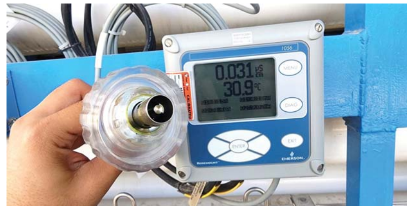
ภาพ แสดงการถอดเซนเซอร์ออกมาทำความสะอาดด้วยน้ำ และที่เช็ดซับบริเวณหัววัด
